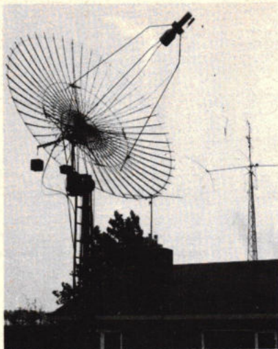
Dergelijke attributen zien we op het dak van de zendamateur, in dit geval de parabool van heer Ottens uit het Zeeuwse ter Hole, PAoSSB. Met deze op de maan gerichte (zelfgemaakte parabool) worden dank zij die maanreflecties long distance verbindingen gemaakt.
